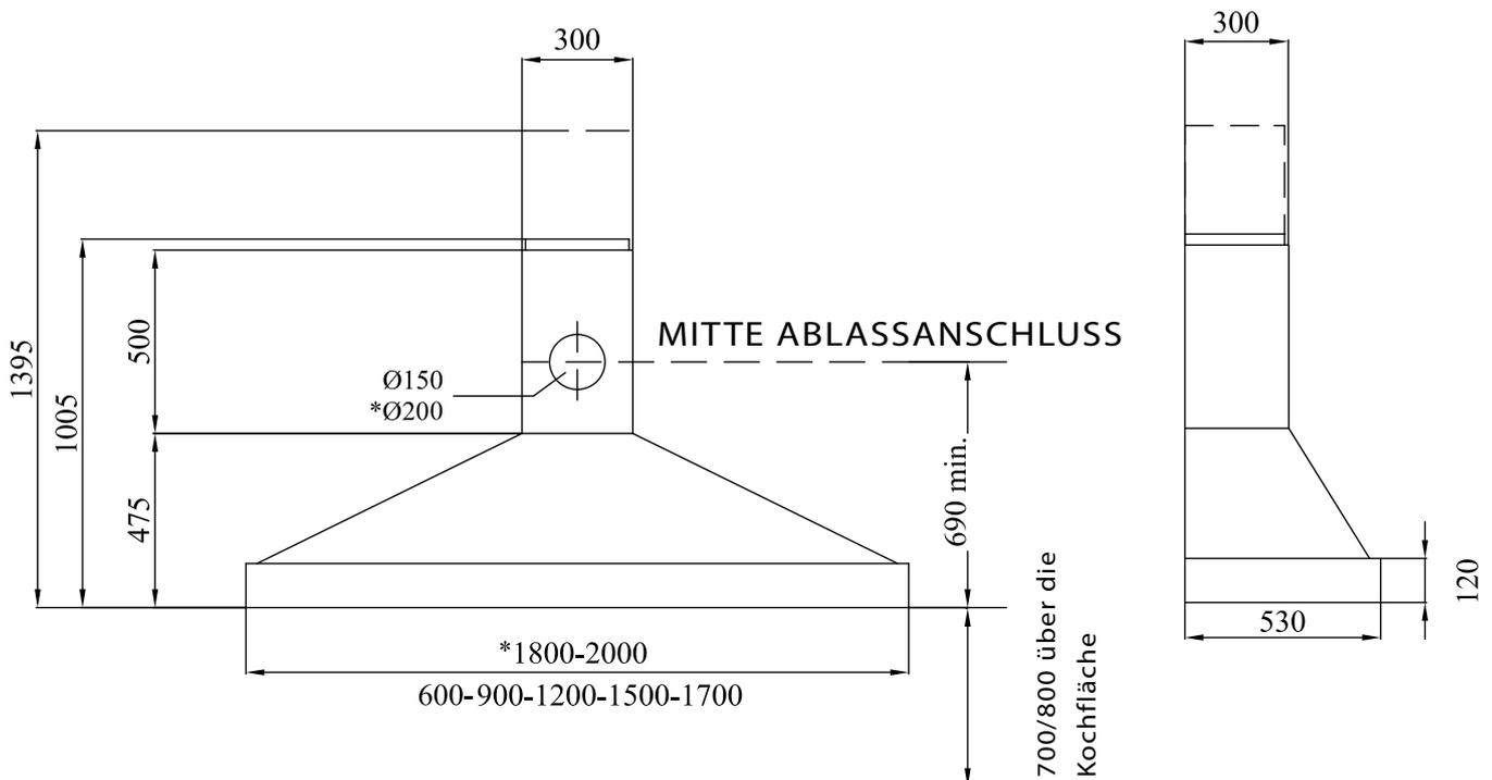
Die Abzugshaube nicht ein einem kleineren Anschluss als vorgesehen anschließen. Es besteht die Gefahr von Fehlfunktionen und Überhitzung des Motors. Wenn die Realisierung den Abluftanschluss  $\varnothing$  200mm (1200mc/h) nicht möglich ist, wie Standard vorgesehen (KA180-200), es wird empfohlen die Abzugshaube mit einem  $\varnothing$  150mm (900mc/h) Motor anzufordern.
